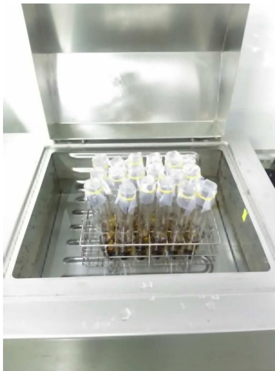
Ảnh 2. Bể ổn nhiệt Waterbaths & Oilbaths (Hãng Memmert, Đức) được sử dụng để điều chỉnh nhiệt độ chiết
