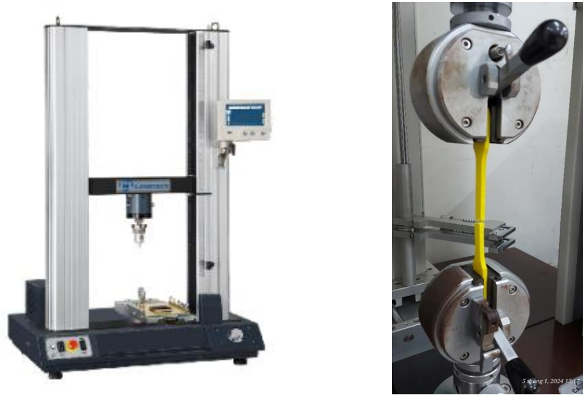
Hình 3: Máy đo lực kéo đứt nhựa.
