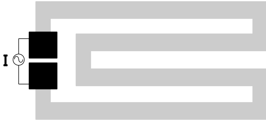
Hình 2. Biên dạng uốn khúc của lớp piezoresistor.
