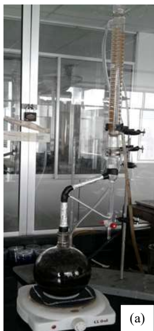
Hình 1. (a) Thiết bị trích li tinh dầu; (b) Sơ đồ khối quy trình trích li tinh dầu
