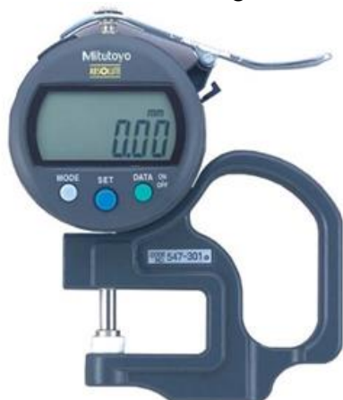
Hình 1: Máy đo độ dày điện tử Mitutoyo 547-301 – Độ chính xác 0.01mm
