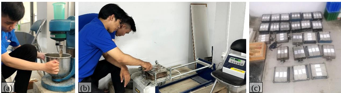
Hình 4: (a) Trộn mẫu bằng máy trộn, (b) đưa vữa tươi vào khuôn, (c) mẫu vữa đông rắn.
