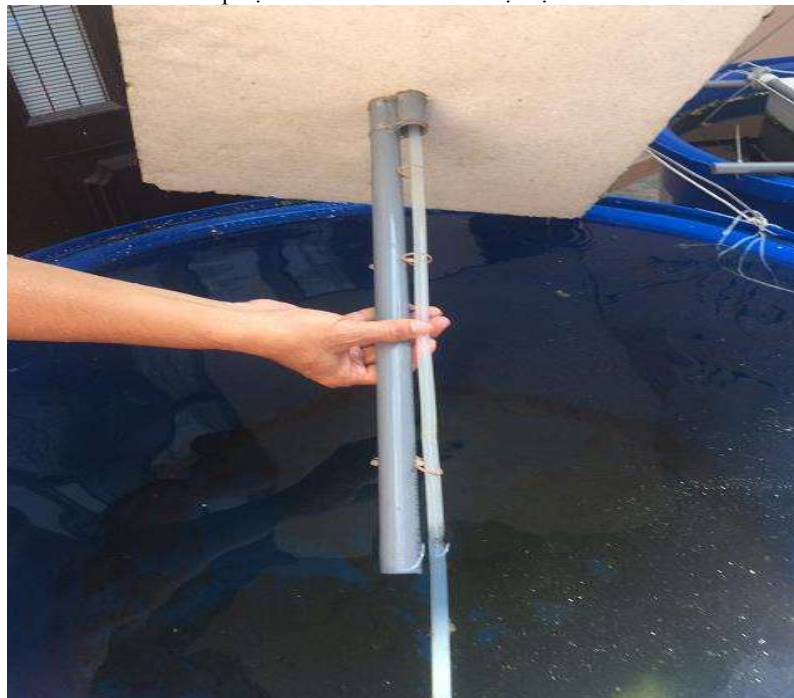
Hình 10. Hình chụp phao nổi được gá vào ống nhựa đỡ.
