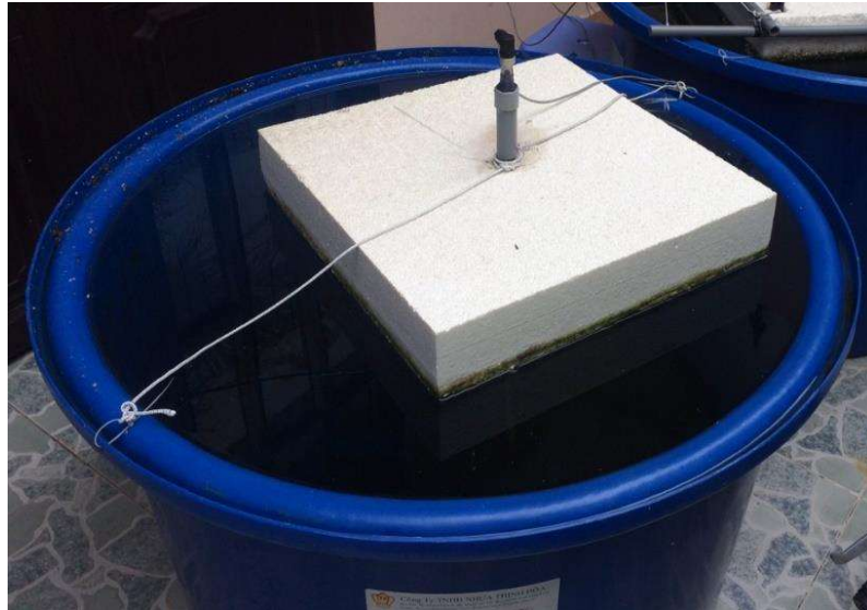
Hình 9. Lắp đặt cảm biến siêu âm đo độ mặn trên bể nước
