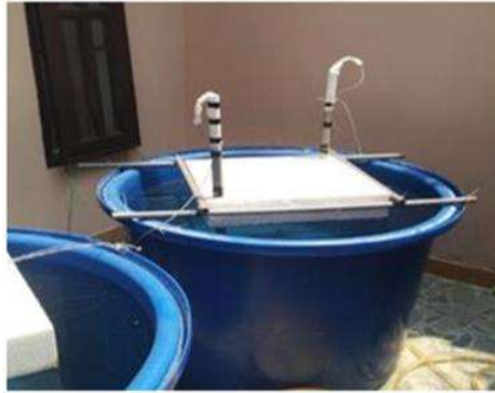
Hình 4. Cảm biến điện cực không tiếp xúc
