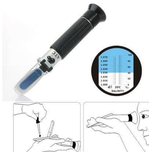
Hình 2. Thiết bị đo độ mặn bằng phương pháp khúc xạ kế
