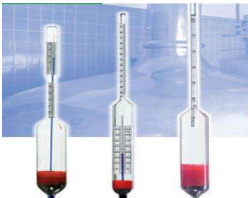
Hình 1. Thiết bị đo độ mặn bằng phương pháp đo tỷ trọng
