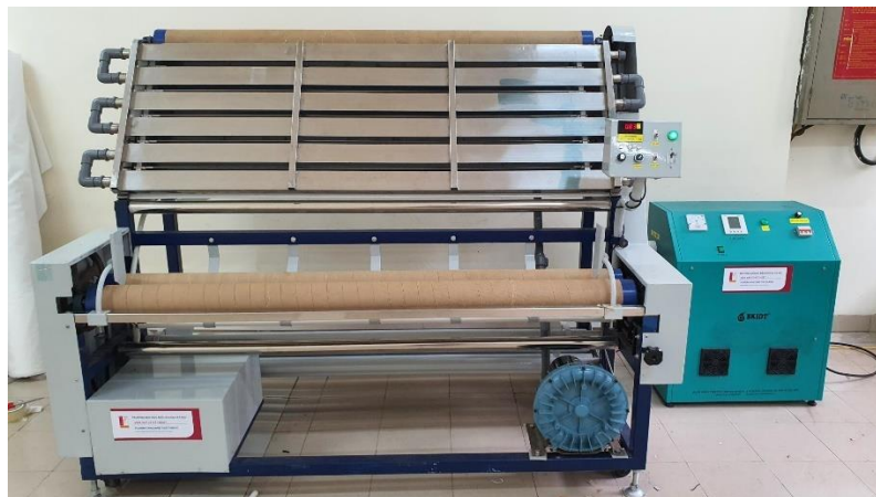
Hình 1: Thiết bị plasma DBD quy mô công nghiệp sử dụng trong nghiên cứu
