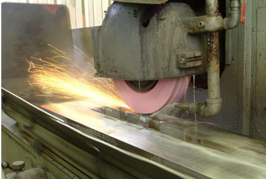
Hình 5: Mài thép SKD61 trên máy mài phẳng CNC
