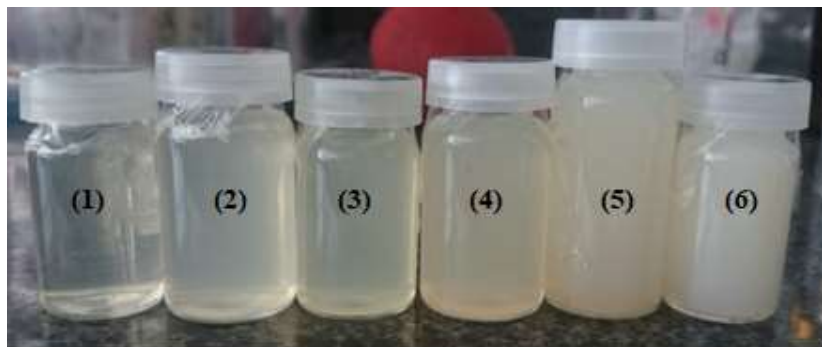
Hình 4: Kết quả đo DLS của các mẫu nano tinh dầu bưởi kết hợp nano bạc. Trong đó, mẫu (1): 0,5 mL tinh dầu + 0,75 mL Tween 80 + 25 mL dung dịch nano bạc + 23,75 mL nước; mẫu (2): 1,0 mL tinh dầu + 1,5 mL Tween 80 + 25 mL dung dịch nano bạc + 22,75 mL nước; mẫu (3): 1,5 mL tinh dầu + 2,25 mL Tween 80 + 25 mL dung dịch nano bạc + 21,25 mL nước; mẫu (4): 2,0 mL tinh dầu + 3,0 mL Tween 80 + 25 mL dung dịch nano bạc + 20 mL nước; mẫu (5): 2,5 mL tinh dầu + 3,75 mL Tween 80 + 25 mL dung dịch nano bạc + 18,75 mL nước; mẫu (6): 3,0 mL tinh dầu + 4,5 mL Tween 80 + 25 mL dung dịch nano bạc + 25 mL nước.
