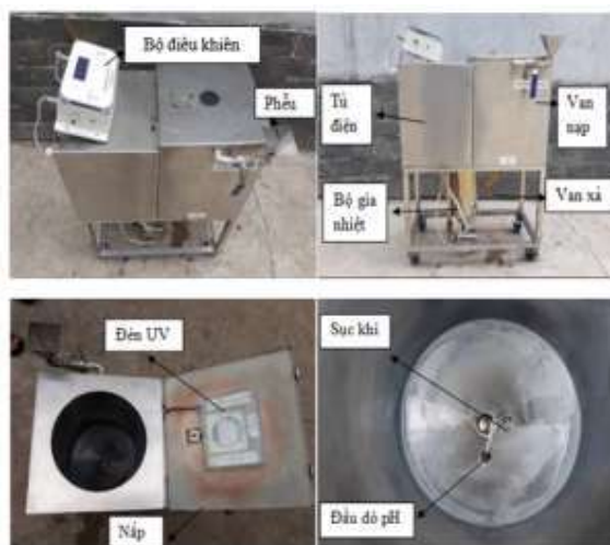
Hình 4. Hệ thống bioreactor thiết kế trên vật liệu inox 304
