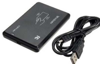
(b) Bộ ghi đọc mã thẻ RFID 13,56Mhz R20C-USB-8H10D [12]
