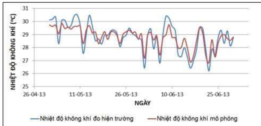
Hình 10. So sánh kết quả mô phỏng nhiệt độ không khí sử dụng cấu trúc ANN 5-5-5-1 và 12 tháng số liệu đầu vào với dữ liệu đo hiện trường cho giai đoạn 1/5/2013 - 30/6/2013
